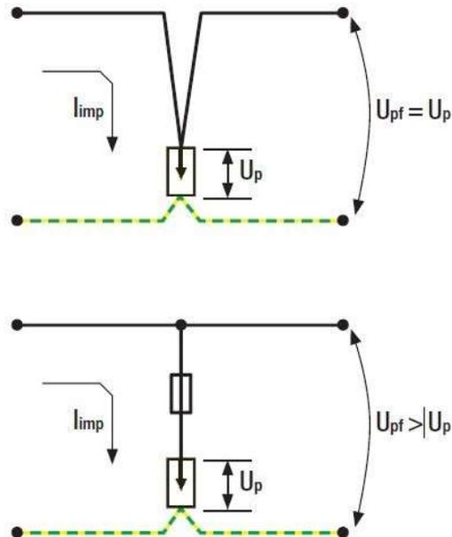
Le spire all'interno del quadro dovranno essere ridotte al fine di ridurre indurre le sovratensioni nei circuiti causato dal campo elettromagnetico generato dalla corrente impulsiva del fulmine nel percorrere i cavi del cablaggio.
