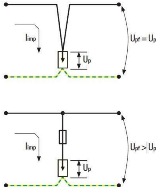
Le spire all'interno del quadro dovranno essere ridotte al fine di ridurre indurre le sovratensioni nei circuiti causato dal campo elettromagnetico generato dalla corrente impulsiva del fulmine nel percorrere i cavi del cablaggio.
