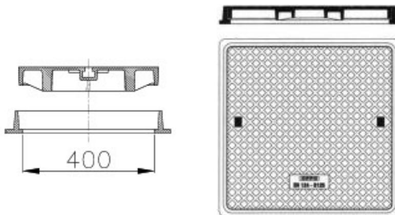
I pozzetti dovranno essere posizionati in corrispondenza di ciascuna derivazione e di ciascun cambio di direzione, ed almeno ogni 30 ÷ 35 m nei tratti rettilinei.
