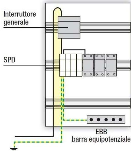
I collettori equipotenziali dovranno essere connessi al sistema di dispersori con percorsi per quanto possibile brevi (usando conduttori più corti di 0,5 m).
